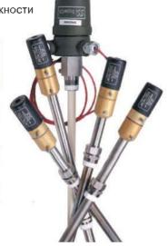
**Датчик GOLD PROBE** – циркониевый датчик кислорода, используемый для измерения углеродного потенциала или точки росы в безокислительной, восстановительной, нейтральной или цементационной среде.
