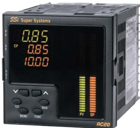
Три строки дисплея контроллера показывают уставку углеродного потенциала, текущее значение углеродного потенциала и один из дополнительных параметров, задаваемых пользователем. Дополнительно на дисплее отображается два столбца барографа, индицирующих текущее и заданное значение углеродного потенциала. Крупные яркие столбцы позволяют оператору издали определить выход печи в рабочий режим.
