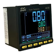
Канал связи - RS485 (протокол Modbus)
